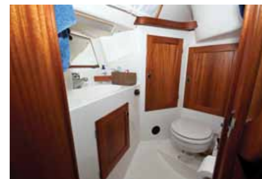
KOMPAKT TOALETT: Toalettet inneholder det nødvendige, inkludert våttøyskap. Det er støpt som egen modul for lett renhold.
