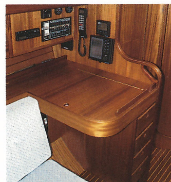
Navigationsbordet är placerat bakvänt akteröver som standard. Men kan lätt vändas.
