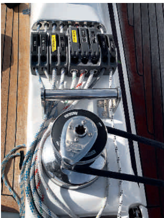
Alle Leinen lassen sich vom Steuerstand aus bedienen
