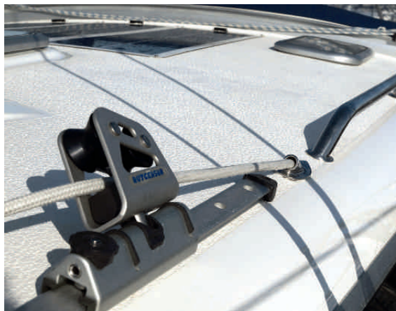
Selbst die Fockschoten verschwinden im Aufbau, eine Selbstwendeeinrichtung ist ebenfalls Standard
