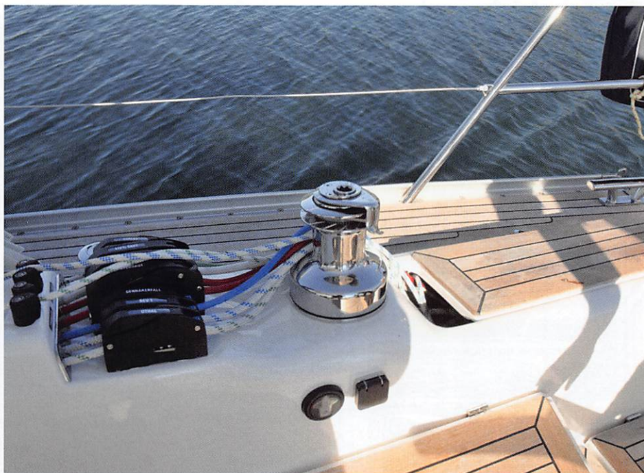
Fallen und Strecker laufen unter dem Kajütdach auf Stopper und einer Winsch.
