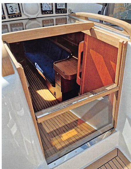
Versenkbare Steckschott, in jeder Position arretierbar
