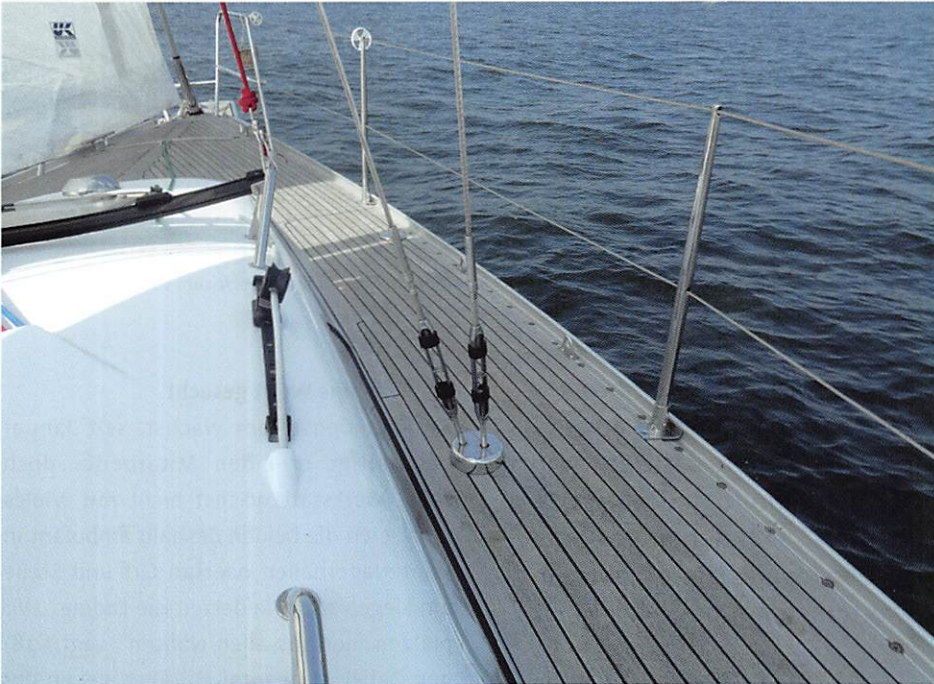
Die Püttinge sitzen weit innen, die Salinge sind kurz, sodass auch eine große Genua gesetzt werden kann.
